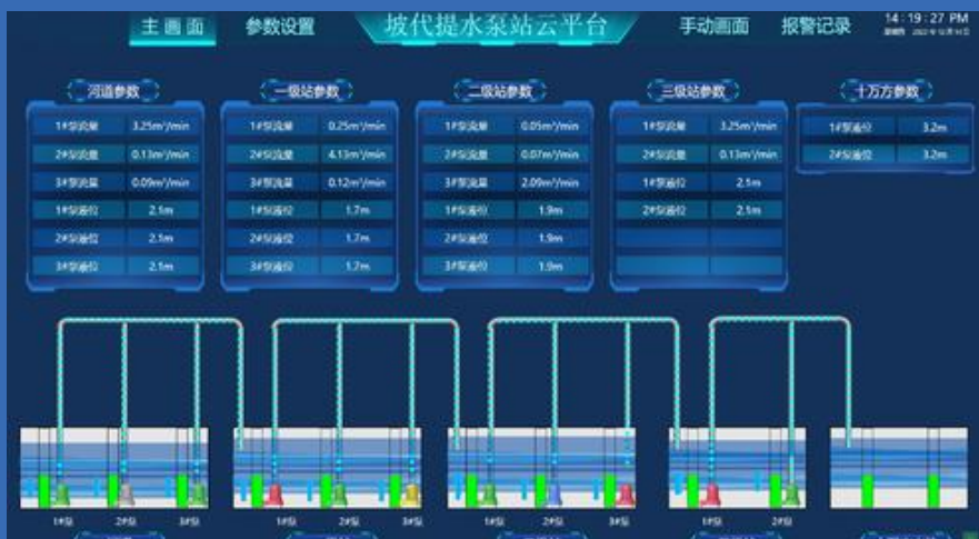
泵站监控系统
